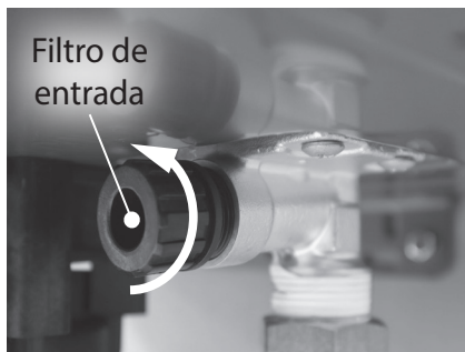
Figura 61 - Retiro del filtro de entrada
