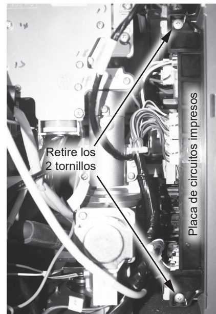
Figura 53 - Retiro de los tornillos de la PCI
