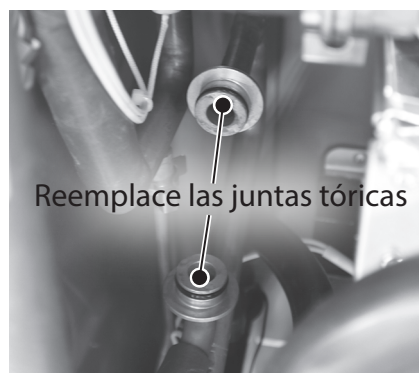
Figura 186 - Reemplace las juntas tóricas expuestas
