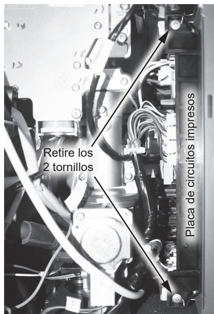
Figura 45 - Retiro de los tornillos de la PCI
