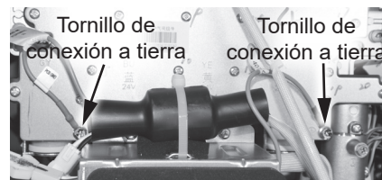
Figura 134 - Retiro de los cables de conexión a tierra verdes
