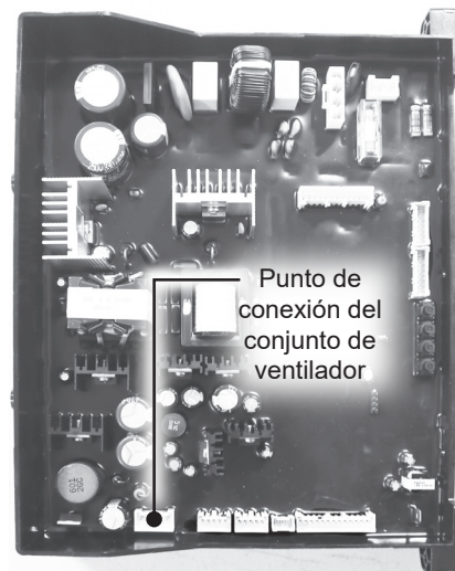
Figura 101 - Desconexión del conjunto de ventilador de la PCI
