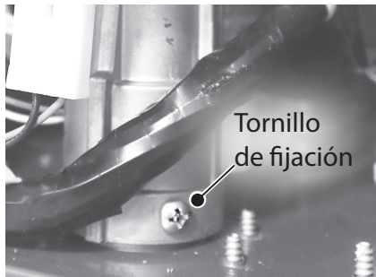
Figura 91 - Tornillo de fijación de la válvula de gas
