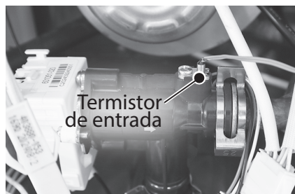
Figura 66 - Ubicación del termistor de entrada de agua
