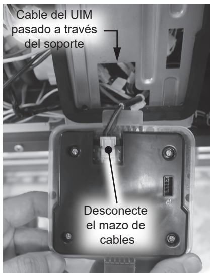
Figura 14 - Desconexión del UIM
