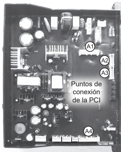
Figura 36 - Desconexión de los cables A1-A4
