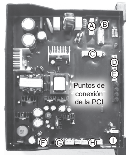
Figura 54 - Desconexión del cableado de la PCI
