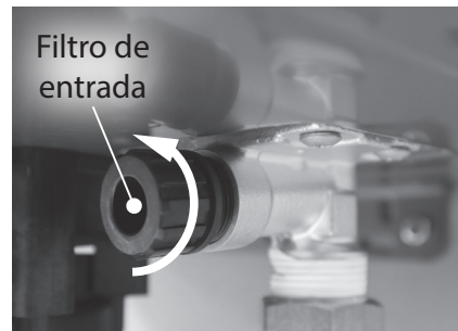
Figura 131 - Retiro del filtro de entrada
