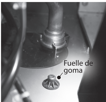
Figura 94 - Verifique la colocación del fuelle de goma
