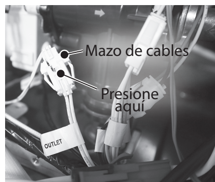
Figura 73 - Ubicación del mazo de cables
